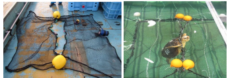
試作したウミガメ脱出装置の概要とウミガメが脱出する様子
